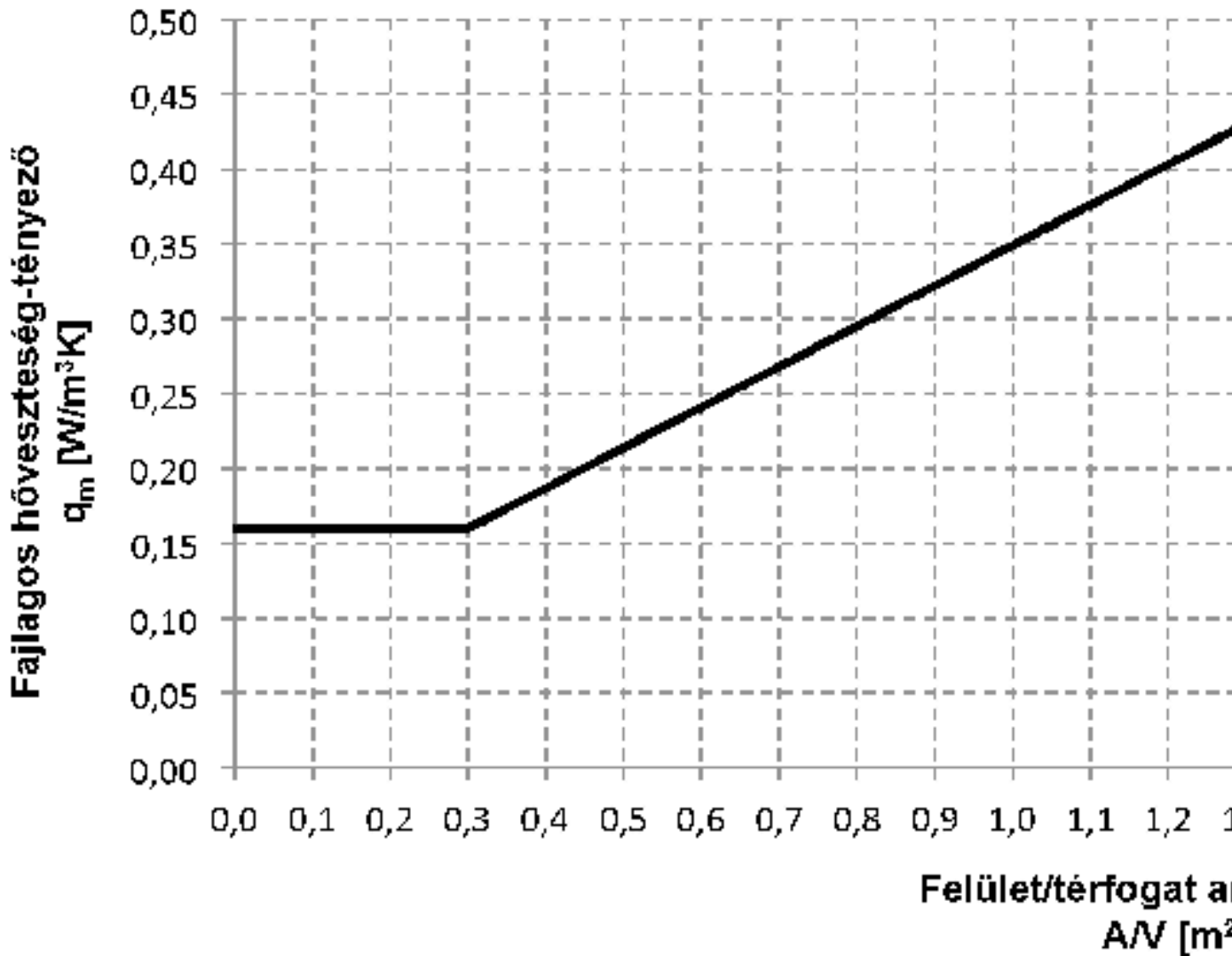
1. ábra. A fajlagos hőveszteség-tényező követelményértéke
