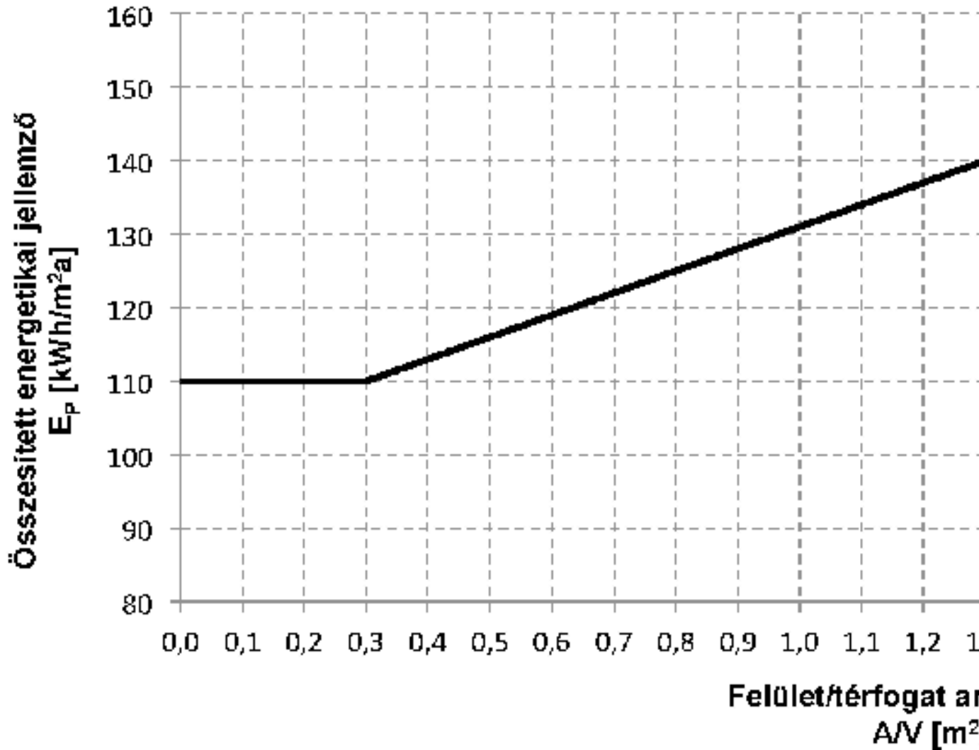
1. ábra: Lakó- és szállásjellegű épületek összesített energetikai jellemzőjének követelményértéke (nem tartalmazza a világítási energia igényt)
